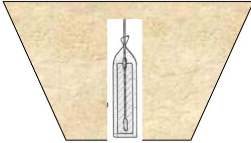
Hacer un tronco de cono de una profundidad de 70 cm. de tal manera que podamos depositar en su base menor el electrodo de grafito preparado para que quede en posición vertical
