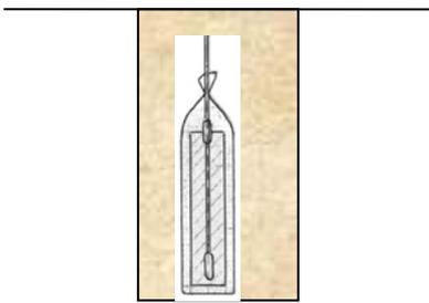
Con la maquina adecuada, hacer un taladro de 150 a 200 m/m de diámetro e introducir el electrodo
