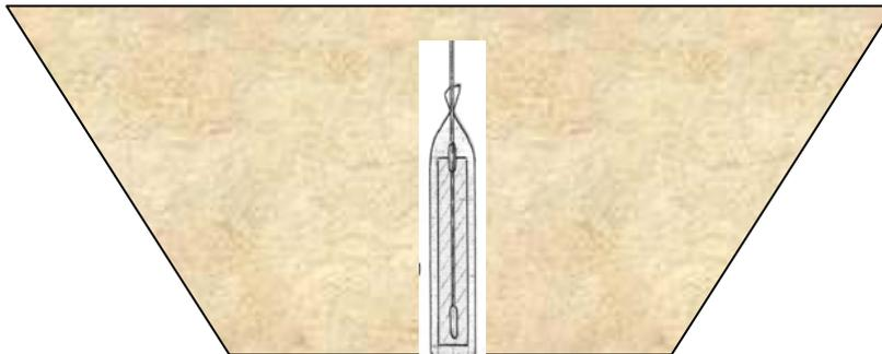
Directamente con maquinaria tipo “pala” hacer un foso o minipiscina y depositar en él el electrodo
